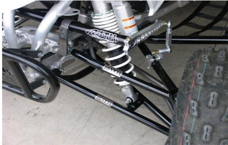
Photo : Barre stabilisatrice avec système de clame
